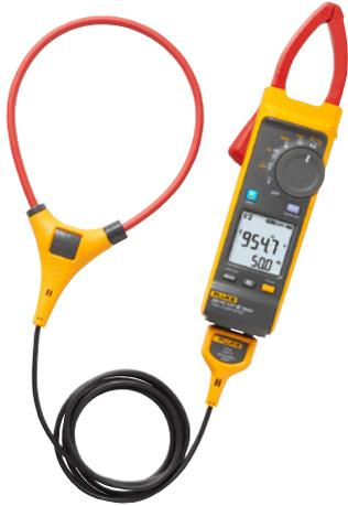
iFlex가 포함된 393FC CATIII 1500 V True-RMS 클램프 미터는 태양광 어레이, 풍력, 전기 철도, 데이터 센터, 배터리 뱅크 등 DC 환경에서 작업하는 기술자를 위해 설계되었습니다. 클램프는 1500 V 전용 테스트리드를 통해 최대 1500 V DC, 1000 V AC 및 클램프 측정집계(jaw)를 통해 최대 999.9 A DC/AC까지 측정합니다. 포함된 iFlex 플렉시블 전류 프로브는 최대 2500 A까지 AC 전류 측정을 확장합니다. 얇은 측정집계(jaw) 디자인의 이 클램프 미터는 비좁은 컴바이너 박스의 케이블에 접근할 수 있도록 해줍니다. 테스트 리드는 고전압 환경에서의 작업을 염두에 두고 설계되었으며 정격은 CAT III 1500V DC입니다.
